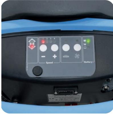
Panel de control analógico, fácil e intuitivo. Regulador velocidad de tracción. Interruptor general de llave, interruptor motor cepillo y motor de aspiración. Disyuntor térmico para proteger motor cepillo y motor de aspiración, indicador de nivel de batería, contador de horas de trabajo
