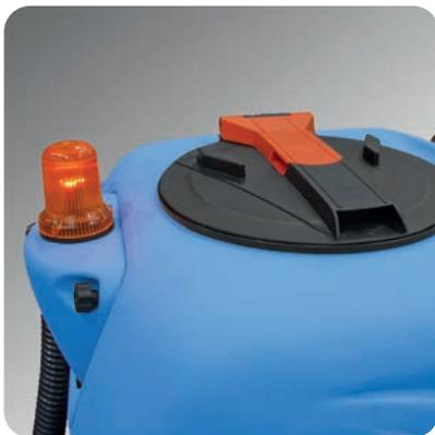
poca visibilidad. La tapa del depósito de recuperación con cierre rápido permite una desinfección y limpieza del depósito rápidas y sencillas; el depósito basculante junto con una manguera de drenaje de gran tamaño permite el vaciado total del depósito y la eliminación de cualquier tipo de residuo sólido. El sistema anti-espuma protege el motor de aspiración, así como el interruptor flotante electrónico que detiene la aspiración cuando el depósito está
