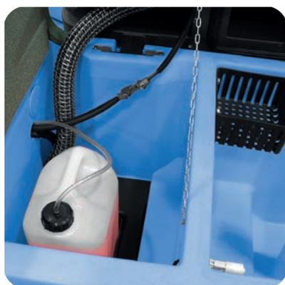
automático. Acceso rápido al depósito de recuperación, fácil de inspeccionar. Acceso rápido al tanque de recuperación. Mantenimiento rápido y fácil de los componentes sin necesidad de herramientas.
