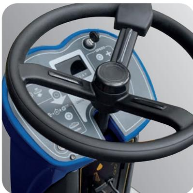
Nuevo panel de control con controles digitales y pantalla. Pantalla digital: con contador de horas, indicador de nivel de carga de la batería, indicador de nivel de depósito de agua vacío, indicador de tracción delantera/trasera. Regulación del control de velocidad, bocina, interruptor del motor de aspiración con apagado retardado, interruptor selector
