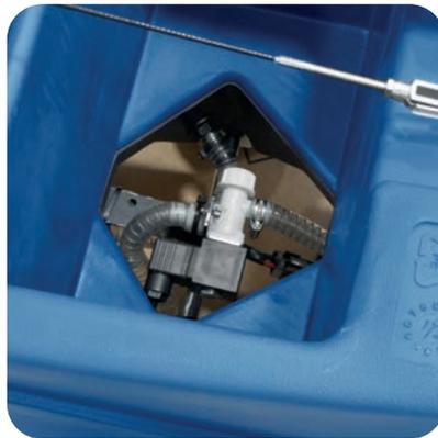
de control que impide la dispensación de la solución de limpieza cuando el cepillo está inactivo durante las interrupciones de trabajo. Controles sencillos e intuitivos. La salida de la solución limpiadora se realiza simplemente mediante el control mecánico
