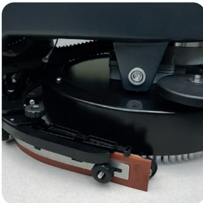
Giro amplio de la boquilla de secado para facilitar su reemplazo y una aspiración perfecta incluso en las esquinas. Configuración fácil y descarga automática de agua sucia para ahorrar químicos y adaptarse a las diferentes condiciones del suelo. Elevada estabilidad y capacidad para superar pequeños escalones. Indicador de nivel del depósito de agua limpia.
